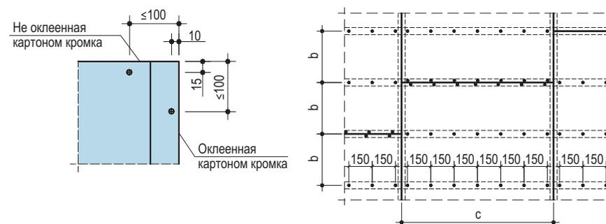
Крепежные шурупы должны входить в гипсовую строительную плиту или гипсоволокнистый лист под прямым углом и проникать в металлический профиль каркаса на глубину не менее 10 мм, а в деревянный брус – не менее 20 мм. Головки шурупов должны быть утоплены в гипсовую строительную плиту или гипсоволокнистый лист на глубину около 1 мм с целью их последующей шпаклевки.
